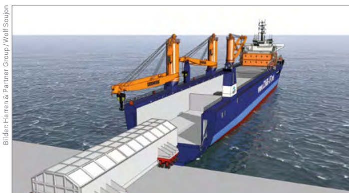
Die Konstruktion der Combi Dock I erlaubt die Verladung im Roll-on-Roll-off-Verfahren
