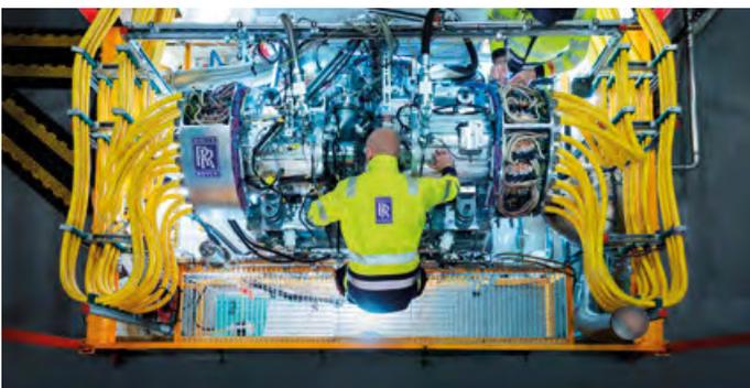
Der 2,5 Megawatt starke Generator-Prototyp auf dem Prüfstand
