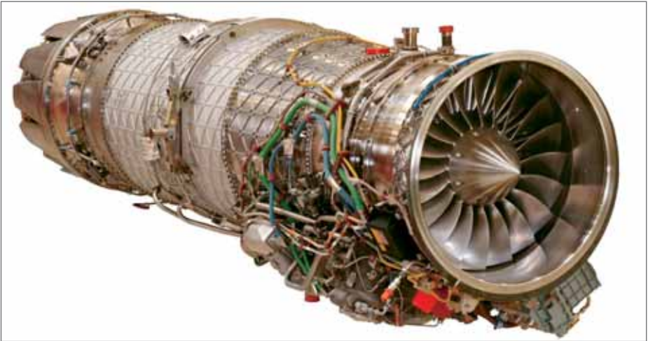
Das Hochleistungstriebwerk Eurojet EJ200 treibt den Eurofighter an.
