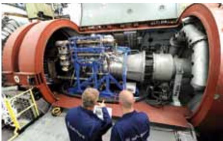
E3E Kerntriebwerk auf dem Höhenprüfstand der Universität Stuttgart
